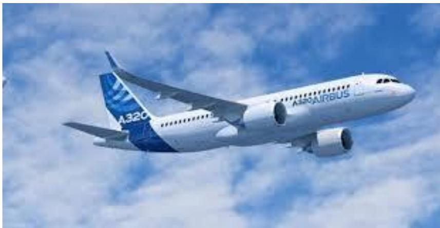
Die Ausgangsthese lautet: Die Passagierflugzeuge der heute üblichen Bauart, wie auf obigem Bild zu sehen, sind eine schalltechnische Fehlkonstruktion. Die Triebwerke hängen unter den Tragflächen. Dadurch werden diese zu Schallschutzwänden nach oben und zu Schallprallwänden nach unten. Es sollte umgekehrt sein. Die Triebwerke sollten über den Tragflächen positioniert sein. Dadurch würden diese zu mitgeführten Schallprallwänden nach oben und Schallschutzwänden nach unten.
